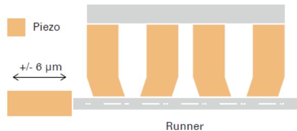
Abb. 2 Hybridkonzept aus Piezoschreitantrieb mit Piezoaktor (Bild: PI)
