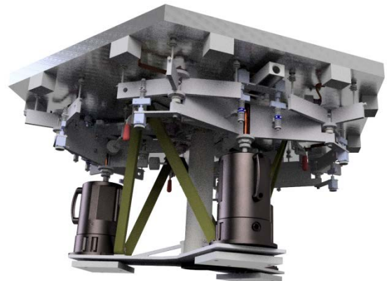
Abb. 5 Konzeption eines M1 Segments (Bild:ESO)
